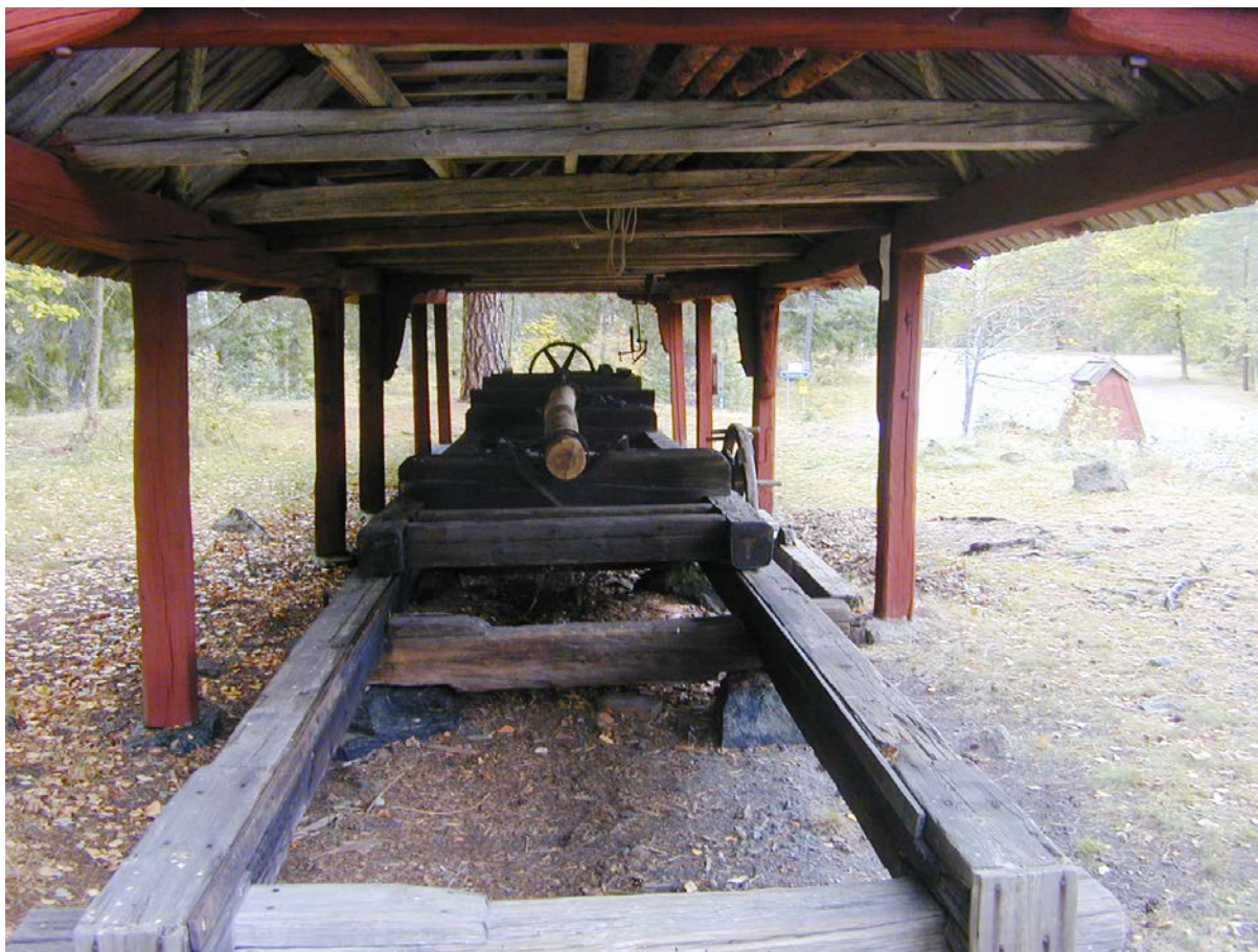
36 Pumpstocksborren 2003. Pipstocken förs mot borrhståelen med hjälp av släden samtidigt som borrhstålet vrids för hand med hjälp av svänghjulet längst bak i blid.
