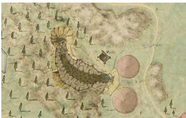
14 Porthålet enligt 1798 års oreviderade karta av J. T Geisler. Ettans schakt var sprängt vid karteringstillfället. Uppföring av malm och vatten skedde med hjälp av de avbildade runda hästvandrarna.
