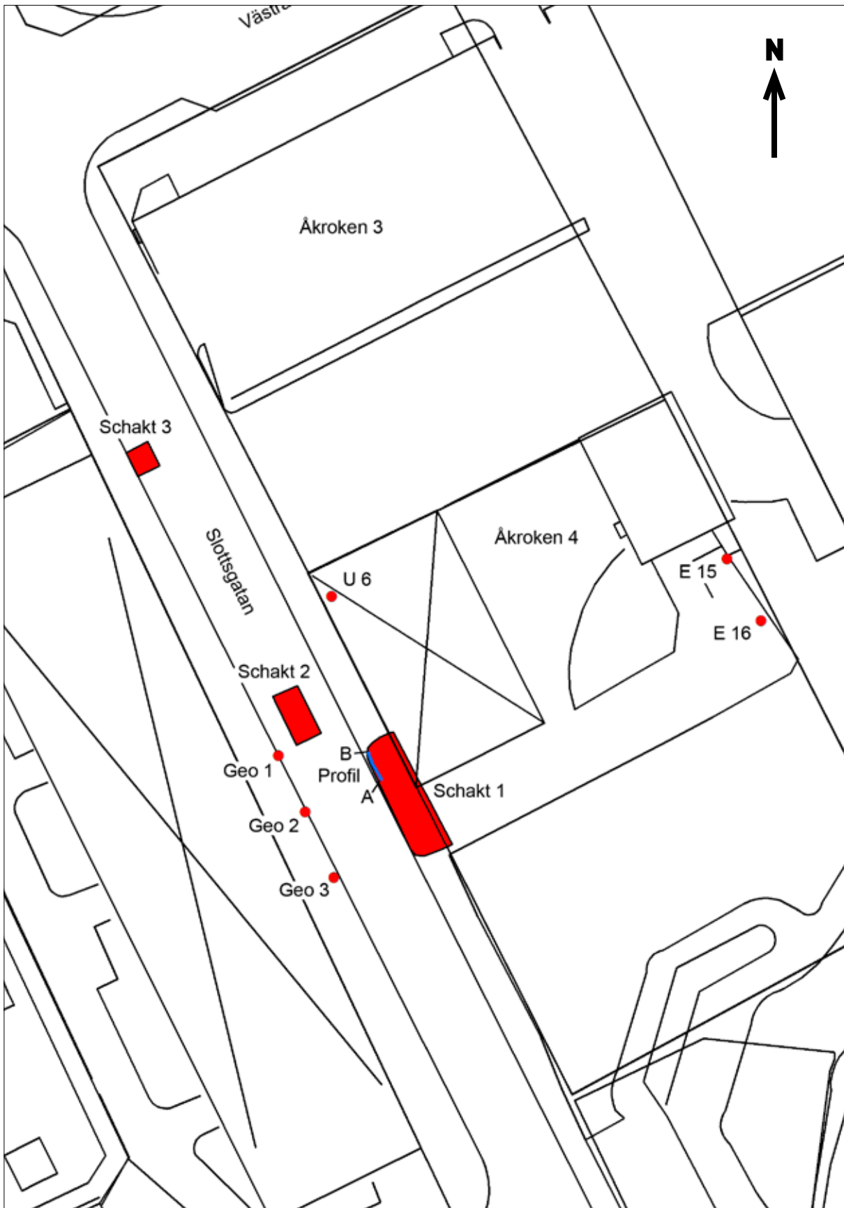
Figur 4. Schaktplan över den aktuella förundersökningen inom fastigheten Åkroken 4 och Slotsgatan, fornlämning Nyköping 231:1, vilken genomfördes som fyra delundersökningar (Del 1-4). Del 1: U6, E15 och E16 är borrhål för stag till spont i kvarteret Åkroken. Del 2: Schakt 1 är schakt för tryckavlastning av spont mot Slotsgatan. Profil A-B är markerad med blå linje. Del 3: Geo 1, 2 och 3 är borrhål för geoteknisk undersökning i Slotsgatan. Del 4: Schakt 2 och 3 är schakt för reparation av vattenläcka i Slotsgatan. Skala 1:400.
