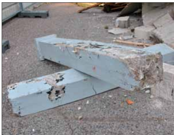
95 Pelarna var gjutna (Slm D2014-367).
